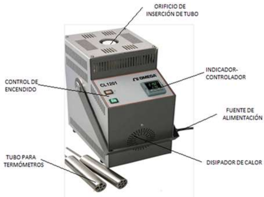
Figura 1.5 Calibrador de bloque seco
