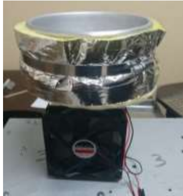
Ensamble de cámara interior con sistema de refrigeración.
