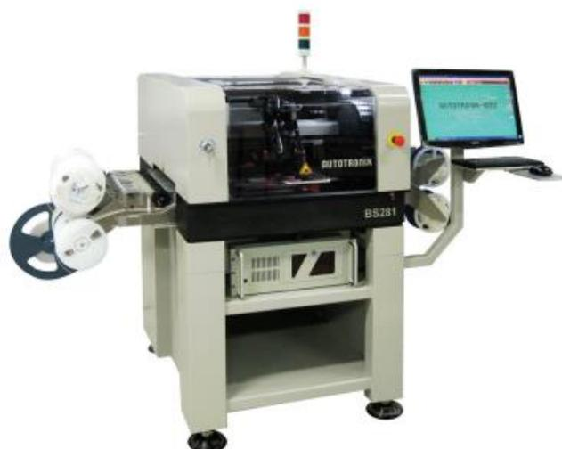
Equipo Pick and Place BS281 del fabricante Autotronic [67].
