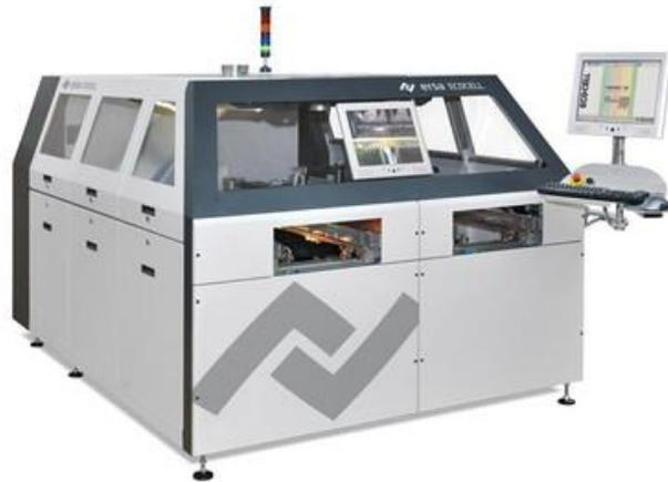
**Equipo ECOCELL soldadura selectiva del fabricante KurtzErsa [72].**
