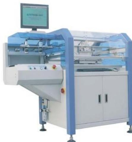
Equipo serigrafía automática BS1400 del fabricante Autotronik [66].
