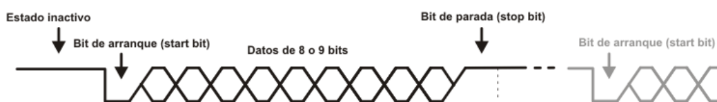
Figura 2.10 Método de Transmisión Serial [11]
