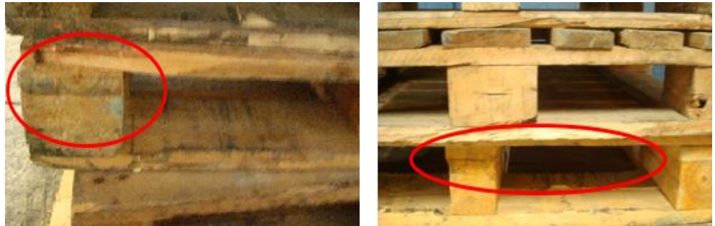
Figura 2.5 Ejemplo Ligero astillamiento de esquina en el elemento superior
