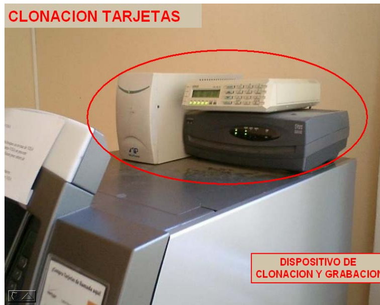
Figura 3.8 Dispositivo de Clonación y Grabación
