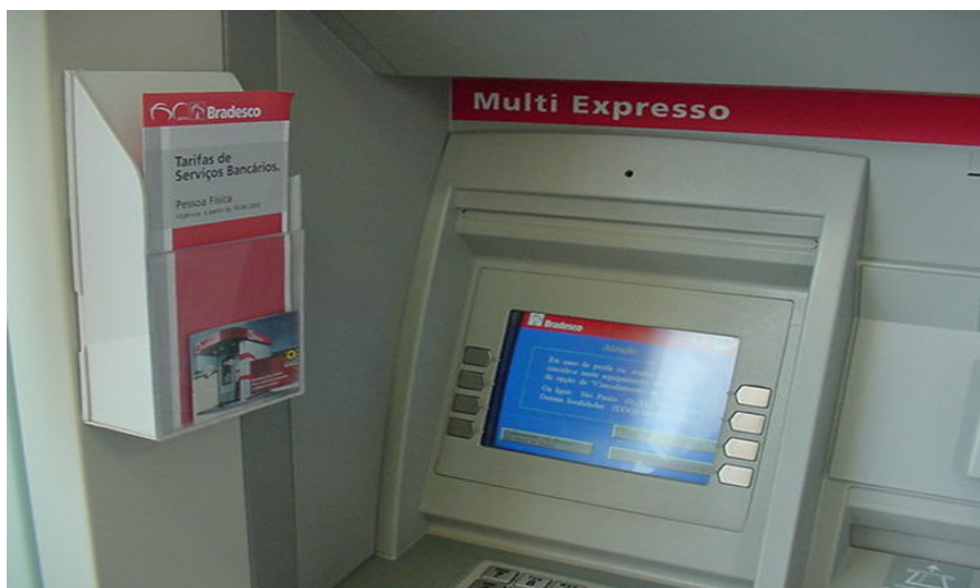
Figura 3.3 Cámara escondida frente Monitor del ATM
