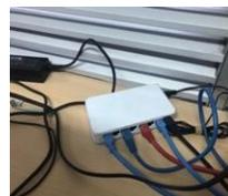
*Switch de 8 puertos marca Dlink*: la funcionalidad de su uso es de proveer de conexión entre el encaminador y la central de VoIP al igual que los equipos informáticos adyacentes como computador portátil y teléfonos IP fijos, los Smartphone y Softphone se conectarán a la central a través de la red WiFi.
