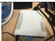
Para esta práctica se optó por la utilización de un encaminador marca Mikrotik modelo 951UI-2HnD por su robustez en características que permiten minimizar el uso e implementación de servidores y equipos de seguridad perimetral para la red WiFi en la que se desea desplegar los servicios de VoIP.
