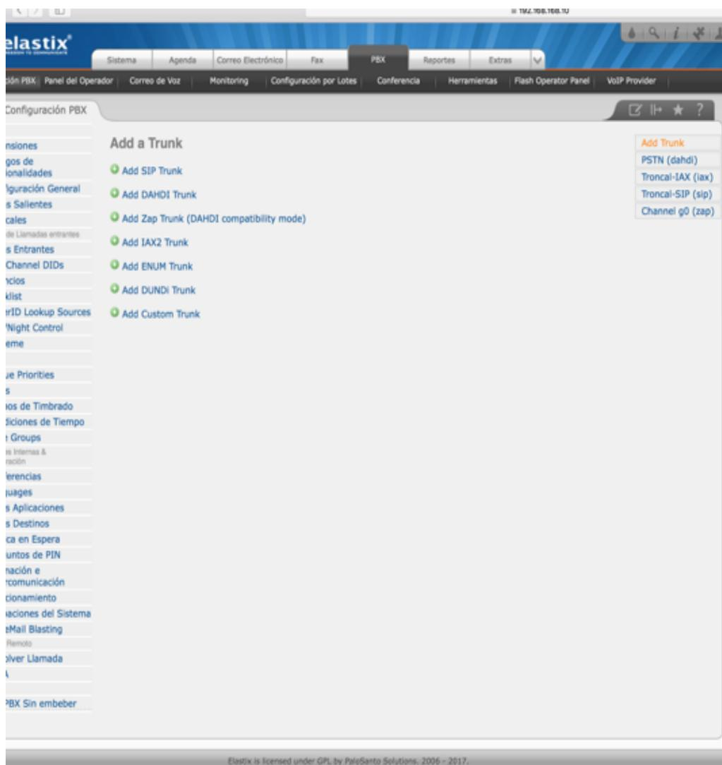
Figura 5. 13 Configuración de la troncal SIP.
