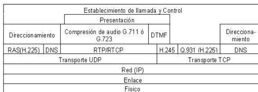
**Figura 2. 4** Pila de protocolos VoIP/H.323 según modelo OSI.
