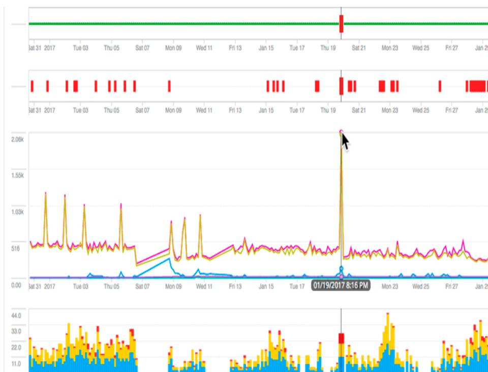
**Figura 5. 32** Escaneo y monitorización en tiempo real de la interfaz de red del servidor de VoIP, saturación de canal de comunicación.
