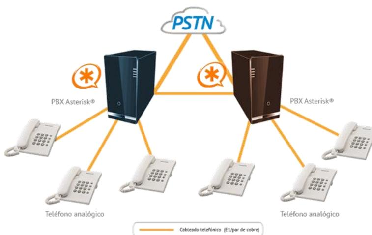
**Figura 4.8** Caso (b) Interconexión Elastix uso de red telefónica y red de datos e Internet.
