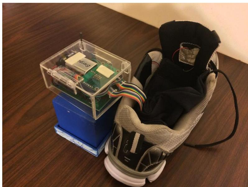
Figura 2.2 Contenedor del dispositivo.
