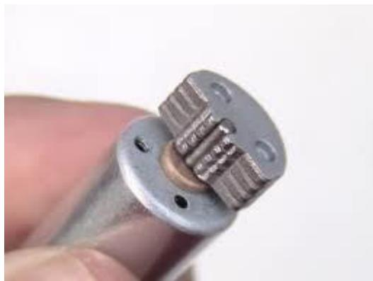
Figura 2.4 Micromotor desbalanceado.
