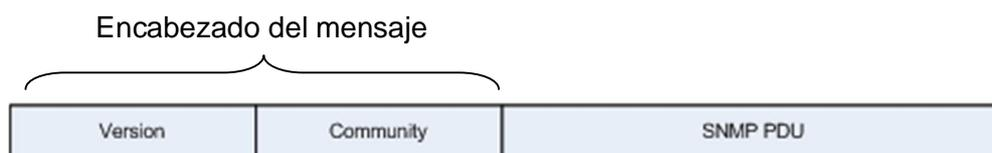
**Figura 2.9 – Formato de mensajes SNMP v1 y v2. [5]**
