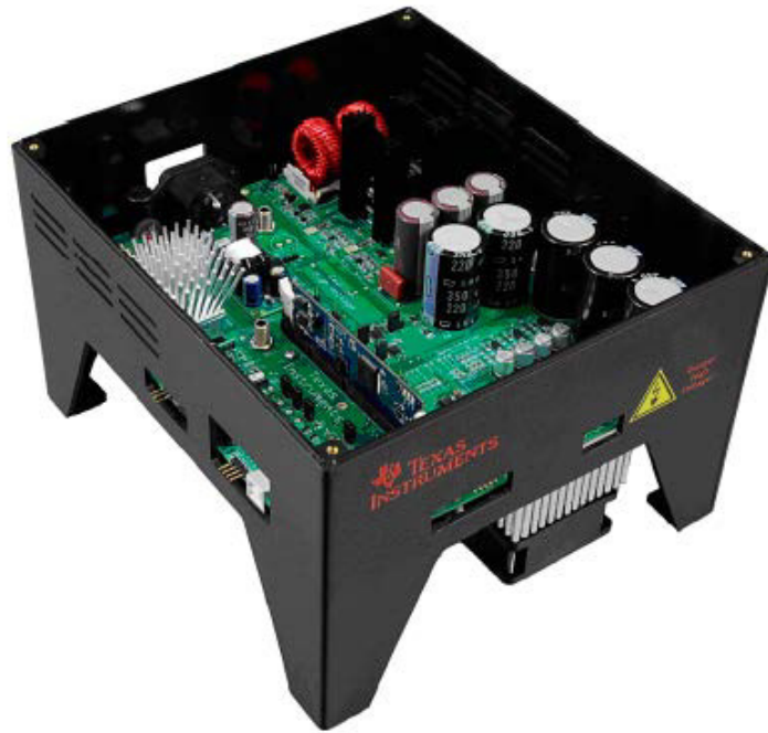
Figura 1.6: Plataforma de desarrollo para el control de motores TMDSHVMTRPFCKIT de Texas Instruments.
