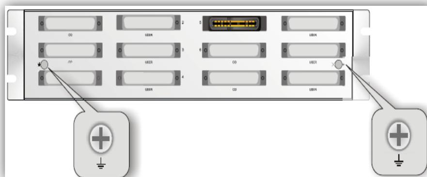
*Figura 4. 10: Puesta a tierra del splitter RU-ST 7324*
