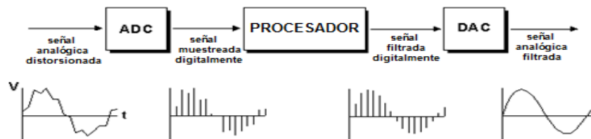
Figura 2.1 Proceso de filtrado digital de una señal analógica.
