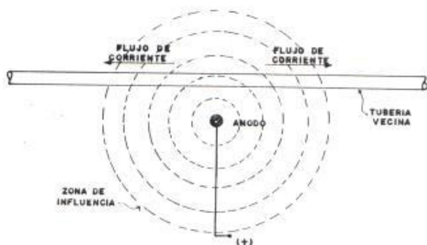
Fig. 6.6.- GRADIENTES DE POTENCIAL CREADOS ALREDEDOR DE UNA CAMA DE ANODOS.
