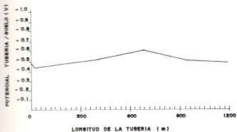
Fig. 2.5.- PERFIL DE POTENCIALES (INSPECCION CON ELECTRODO REMOTO).
