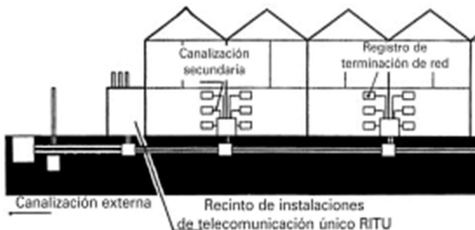
Fig. 5.28 Instalación de Cajas Dispensoras [18]
