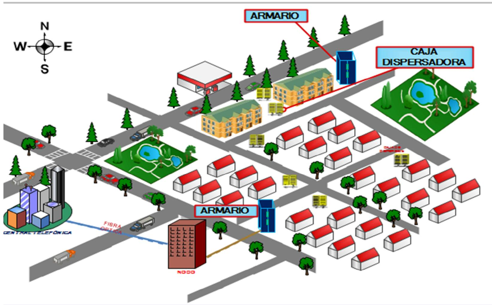
Fig. 5.2 Diseño de Red de Planta Externa en Urbanización
