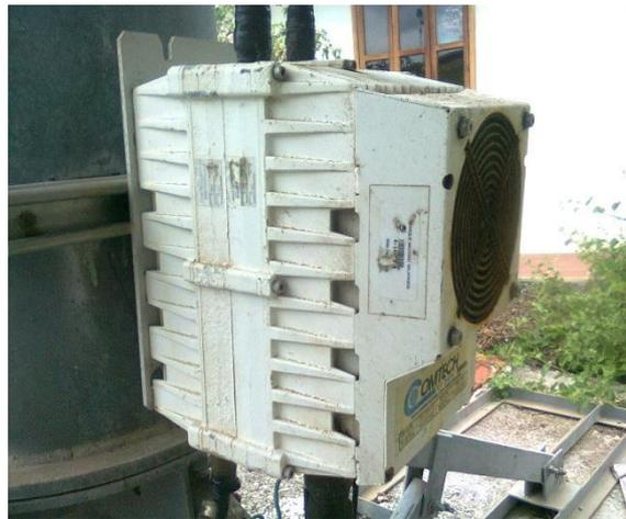
Figura 3. 11: Transceptor de potencia de 5 watts.
