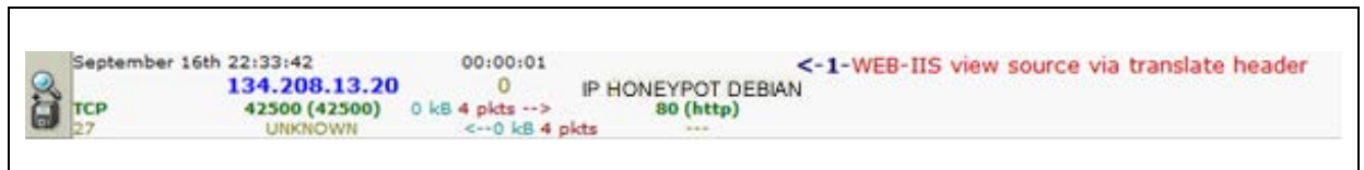
Figura G.1.9 Alerta de Snort visualizada por el Walleys / WEB-IIS view source via translate header
