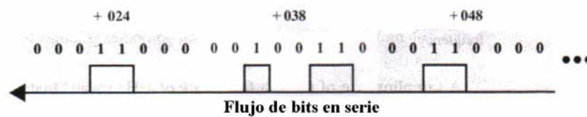
Figura 5.7 Transformación en señal digital de los dígitos binarios
