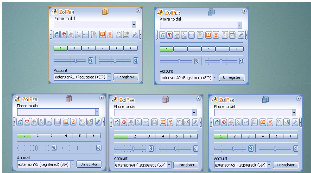
Fig. 5.32 Cuentas SIP registradas en zoiper(servidor A)
