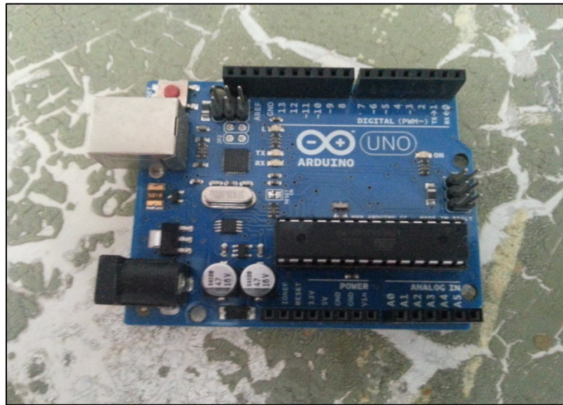
Figura 2.12. Apariencia física del Arduino 1.0
