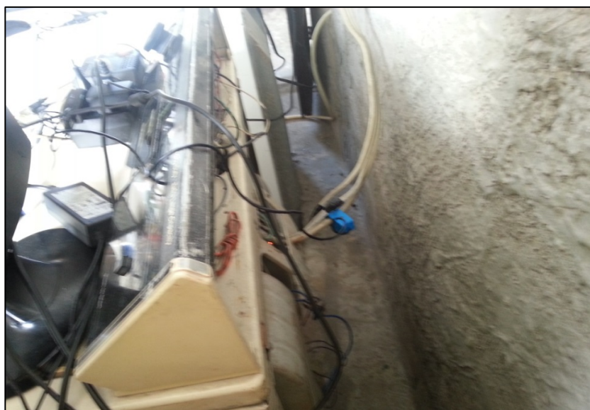
Figura 4.16. Adaptación del sensor de corriente SCT-013-030 al cable de alimentación de la secadora de ropa a 220 V
