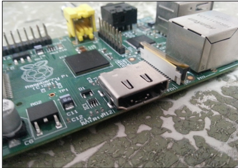
Figura 2.4. Salida de video HDMI en la Raspberry Pi
