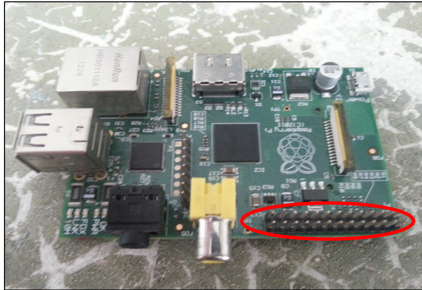
Figura 2.7. Localización del puerto GPIO en la Raspberry Pi
