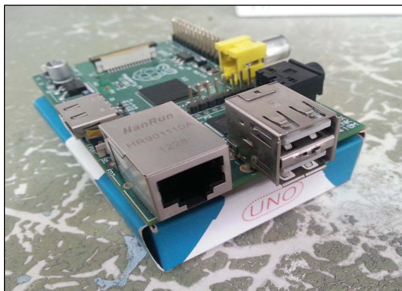
Figura 2.5. Conectores USB para el teclado, el mouse y puerto Ethernet para acceder a la red
