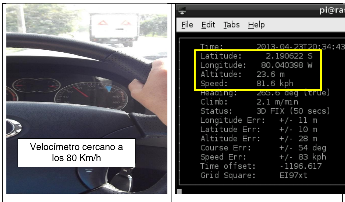
Figura No. 4.15 Adquisición de datos del módulo GPS mediante el Software GPSD – Auto en Movimiento.
