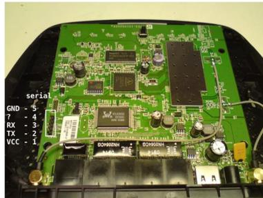
**Fig. 2.9** Interior Enrutador Linksys WRT160NL
