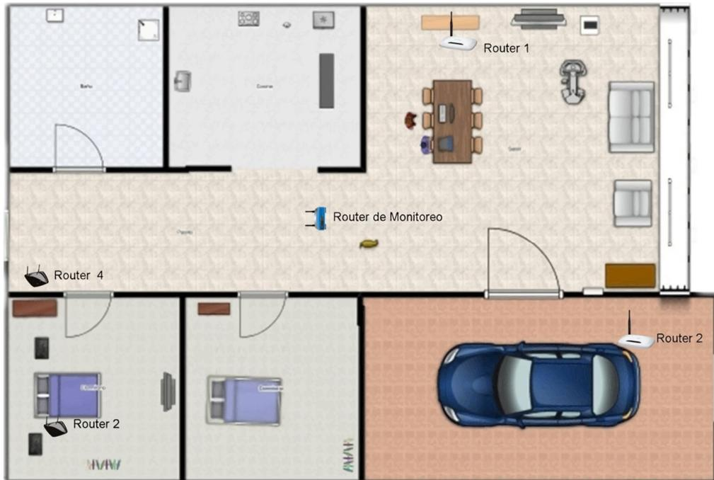
**Fig. 4.5** Esquema de ubicación de los enrutadores dentro de la locación
