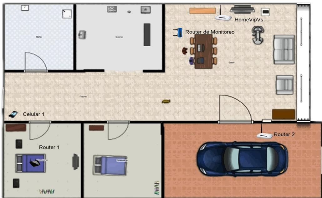
**Fig. 4.1** Esquema de la disposición de los equipos al momento de tomar los datos
