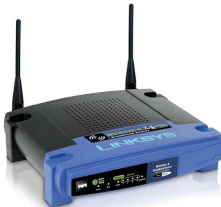
**Fig. 3.1** Enrutador Linksys WRT54GL
