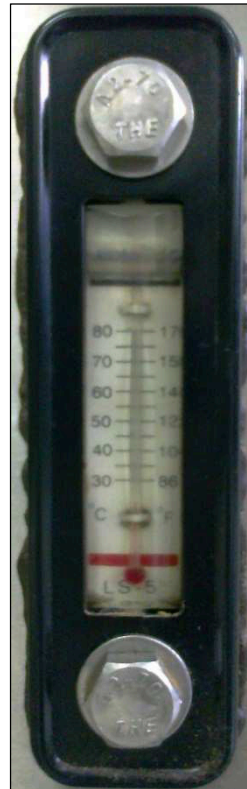
Figura 1.7. Visor del Nivel de Agua del Reservorio
