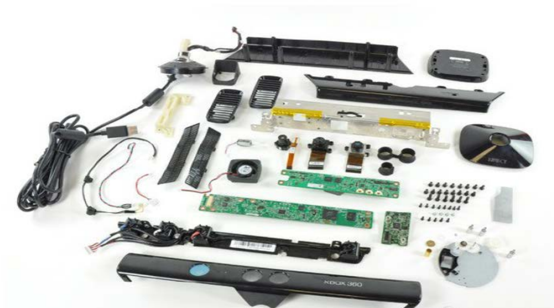
Figura 1.4 Partes que conforman el Kinect de la Xbox 360 de Microsoft [17]
