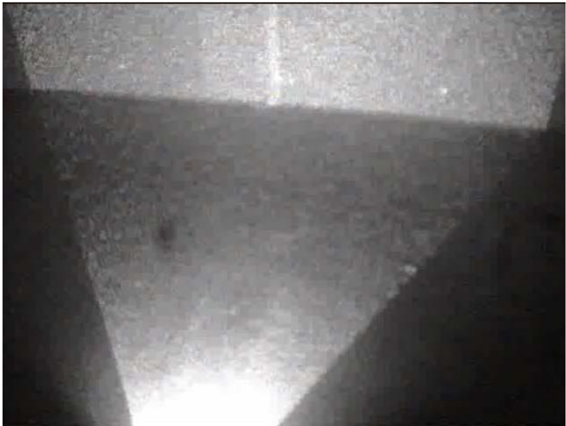
Figura 4.17 Haz de luz que proyecta el Kinect vista desde una cámara infrarroja
