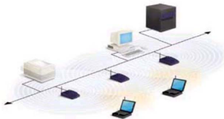
Figura 2.5.: Configuración de red con punto de acceso [22].
