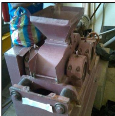
**Figura 3.2 Trituradora de rodillos.**
