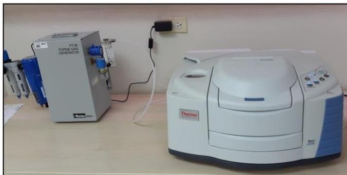
**Figura 3.22 Espectrómetro Infrarrojo de la Transformada de Fourier.**
