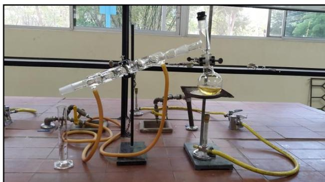
**Figura 3.12 Sistema de Destilación simple.**
