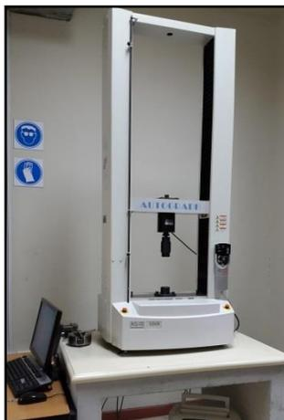
**Figura 3.17 Máquina de Ensayos Universales 10kN.**
