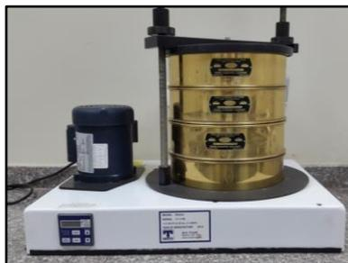
**Figura 3.7 Agitador de tamices.**
