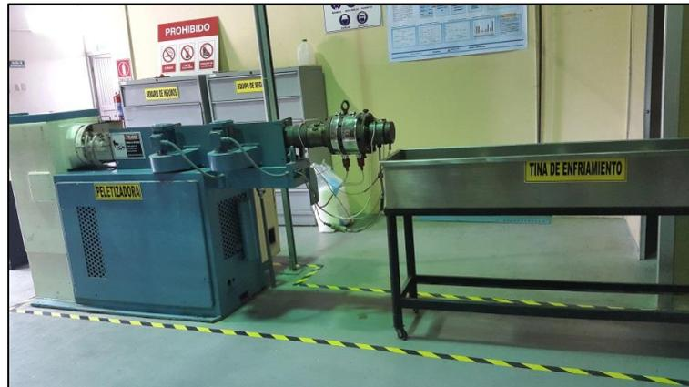
**Figura 3.15 Extrusora de tornillo simple – peletizadora.**
