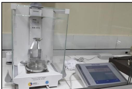
**Figura 3.24 Balanza para determinación de densidad.**
