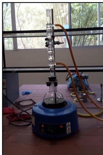
**Figura 3.13 Sistema de Calentamiento con reflujo de condensado.**
