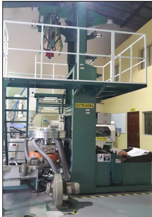
**Figura 3.16 Extrusora de soplado.**
