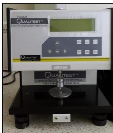
**Figura 3.23 Equipo medidor de espesores.**
