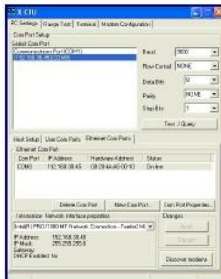
A continuación, después de añadir nuestro nuevo dispositivo, debemos señalar en la ventana "Select Com Port" dicho dispositivo, y seleccionamos el botón "Test/Query". Nos aparecerá una ventana como la que aparece en la siguiente imagen.
