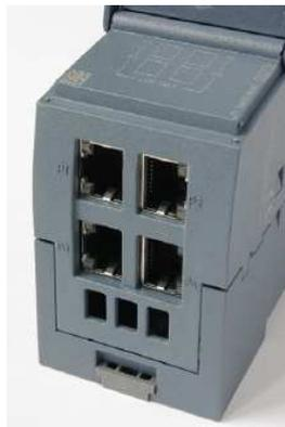
Figura 3.7.- Switch Ethernet
