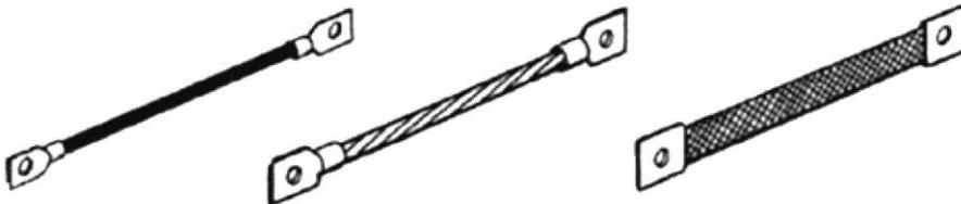
**FIGURA 7.** Cables puentes de unión.
