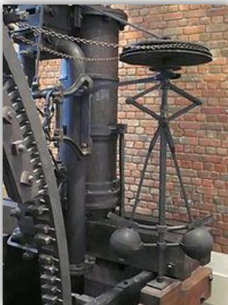
**Figura 1.1** Regulador centrífugo. [1]
