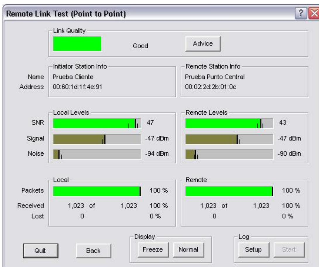
**Figura A.25:** Prueba de enlace de radio entre punto central a un cliente.
