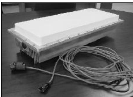
**Figura 14.** Tsunami Unidad Base Multipunto.
