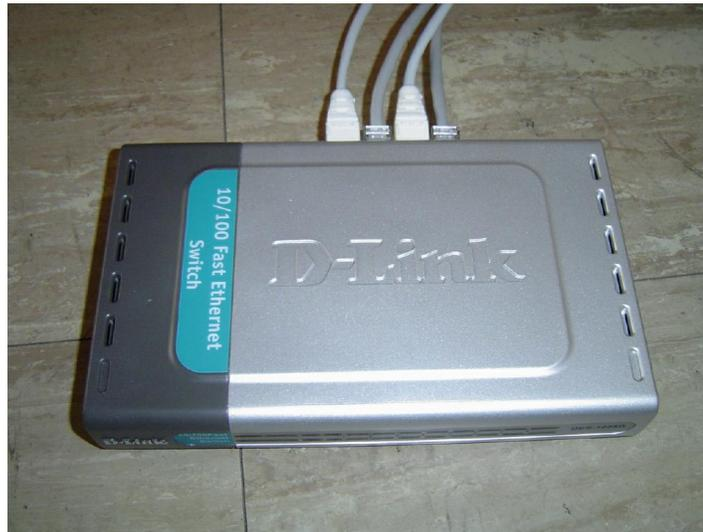
Figura 4-3 *Switch* Ethernet de 10/100 Mbps
