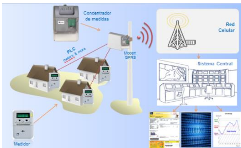
Figura 1.1: Esquema de funcionamiento de un medidor inteligente [18]
