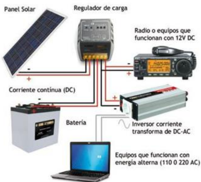
Figura 2.8: Esquema de conexión de un sistema fotovoltaico [8]
