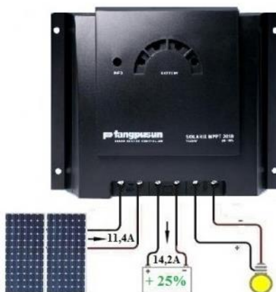
Figura 2.6: Esquema de funcionalidad de un controlador de carga [17]
