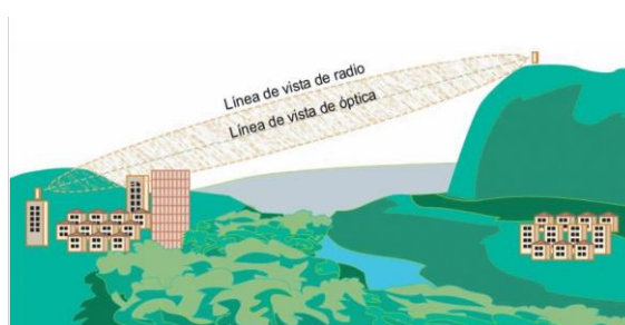
Figura 2.3: Enlace con línea de vista [4]
