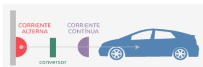
**Figura 1.7: Modo 4 para carga rápida en CC**
