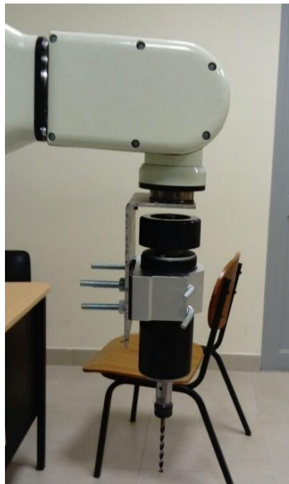
Figura 3.22: Montaje del Motor en el Brazo Robot.
