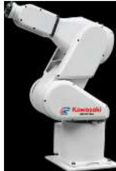
Figura 2.3: Brazo robótico RS03N KAWASAKI. [2]
