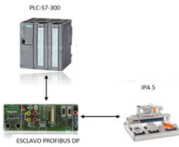
Figura_GP 11: Diagrama del sistema.
