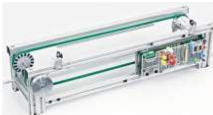
Figura 2.9: Segmento de cinta transportadora doble de 24V. [6]
