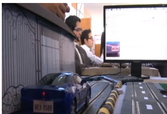
Figura 3.16: Captura de la placa del vehículo con el prototipo.
