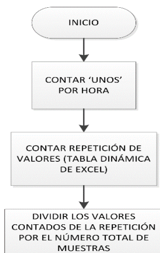
Figura 3.5 Algoritmo de Tratamiento de Datos para posterior hallazgo de Probabilidad Individual (pdf) y Probabilidad Acumulada (cdf)
