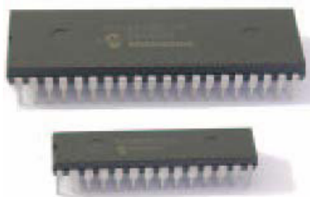
FIGURA 5.8. MICROCONTROLADORES FABRICADOS POR MICROCHIP. EL PEQUEÑO, ES EL PIC18F252.
