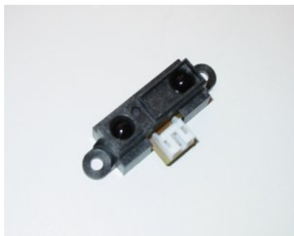
FIGURA 5.16. SENSOR DE MEDIDA DE DISTANCIA GP2D12.
