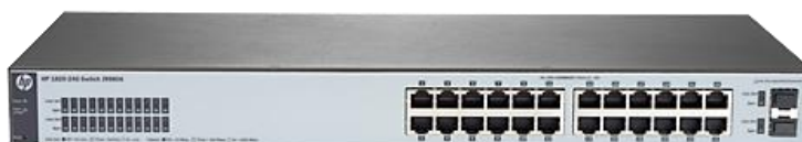
Figura 3. 8 Vista del Switch HPE 1820 de 24g
