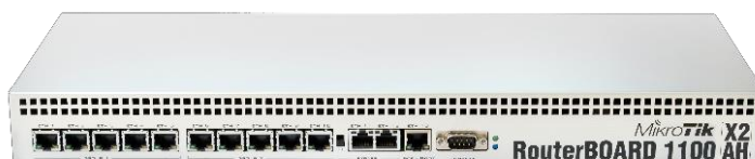
Figura 3. 6 Vista frontal del Router Mokrotik 1100 AHX2
