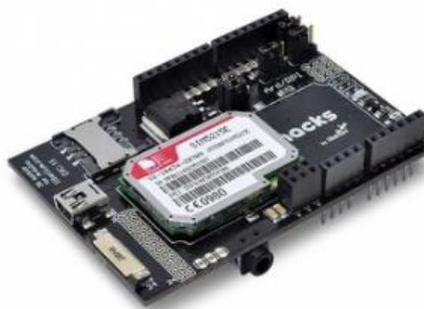
**Figura 2.4: Módulo SIM 5125 3G/GPRS**
