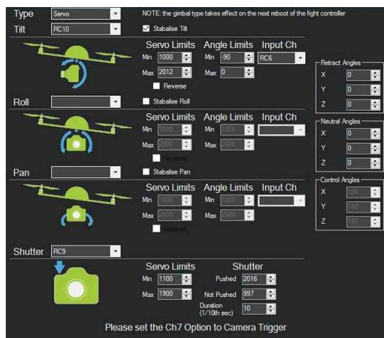
**Figura 3.10 Configuración del Gimbal.**
