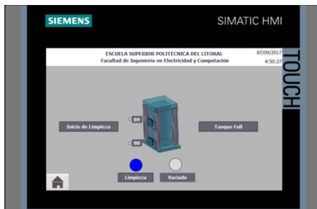
Figura 4.6: Pantalla HMI – Proceso de Limpieza y Vaciado.
