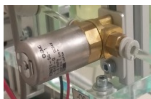
Figura 2.10: Válvula de distribución de 2/2 vías.
