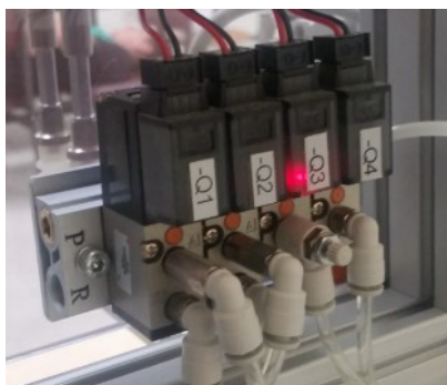
Figura 2.11: Válvulas de distribución de 3/2 vías y 4/2 vías.
