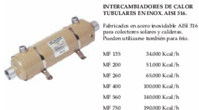
Fig. 3.7 Intercambiador de calor tubular
