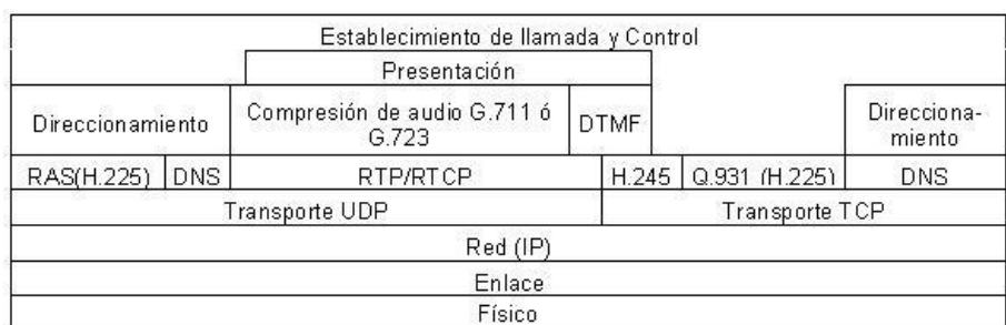
Fig. 2.23. Pila de protocolos en VoIP
