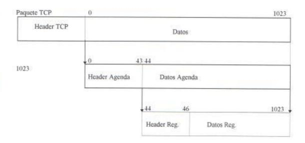
Como se puede observar en el diagrama, dentro del paquete TCP, la parte de los datos, contiene el buffer de nuestra aplicación. El buffer contiene el Header Agenda, que es la cabecera del buffer que usará nuestra aplicación, y en la que se define el protocolo a usarce. En Header Reg, se contiene una pequeña cabecera que se ha definido por registro, esta sirve a los registros correspondientes a las actividades de la agenda y a los registros de usuarios.
