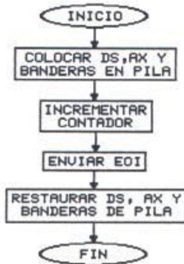
Figura 5.12 Diagrama de flujo del procedimiento "contar"
