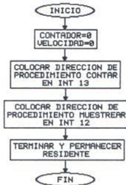
Figura 5.11 Diagrama de flujo del programa "contador.com"
