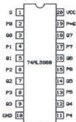
Figura 4.2 Diagrama de conexión del 74ALS688
