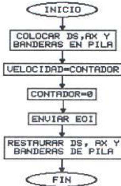
Figura 5.13 Diagrama de flujo del procedimiento "muestrear"
