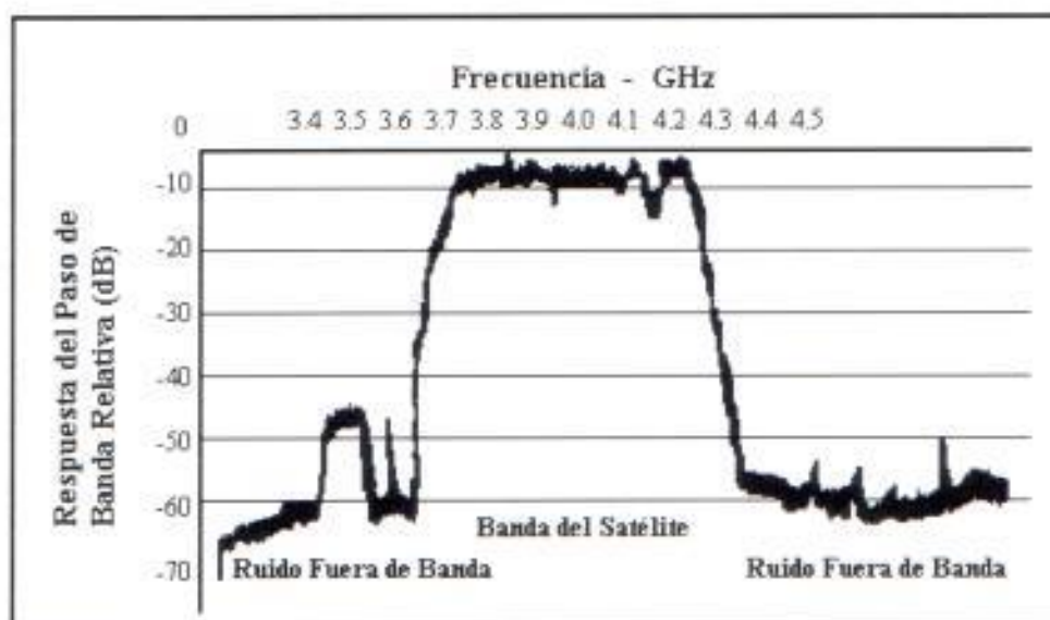
Fig. 3.16 LNA con Filtro de Paso de Banda Incorporado. Este gráfico muestra cómo un filtro de paso de banda rechaza las frecuencias fuera de la gama de la banda C de satélites.
