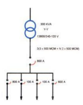
Con los datos medidos de potencia trifásica para la fecha de lectura, 7 de Octubre (Lunes), no podemos determinar con certeza el sobredimensionamiento del Banco, la máxima potencia medida ha sido de 8 KW en comparación con la capacidad del Banco la cual es de 300 KVA. Solo podemos asegurar que las cargas mayores no han entrado en funcionamiento en este día.
