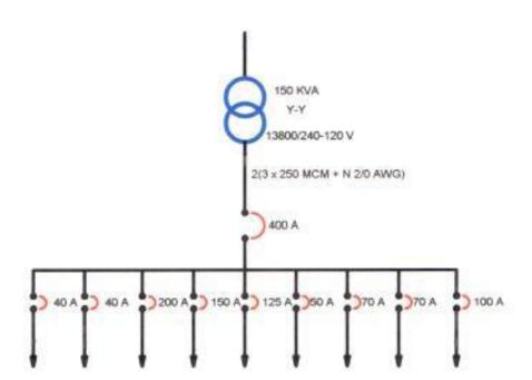
Con los datos de Potencia obtenidos, se ha determinado un sobredimensionamiento del 1000% aproximadamente, pero cabe señalar que en esta área de mantenimiento existe una carga de luminarias estimada en 15 KW, las cuales generalmente no funcionan debido a que no hay personal laborando en horas de la noche.
