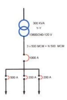
En este caso, se observa que las fases también están balanceadas, y se tiene un sobredimensionamiento notoriamente del banco de transformadores (330 Kw) del 300 % con respecto a la potencia máxima medida (90 Kw).
