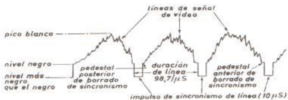
Tres líneas de señal de video con los impulsos de sincronismo.
