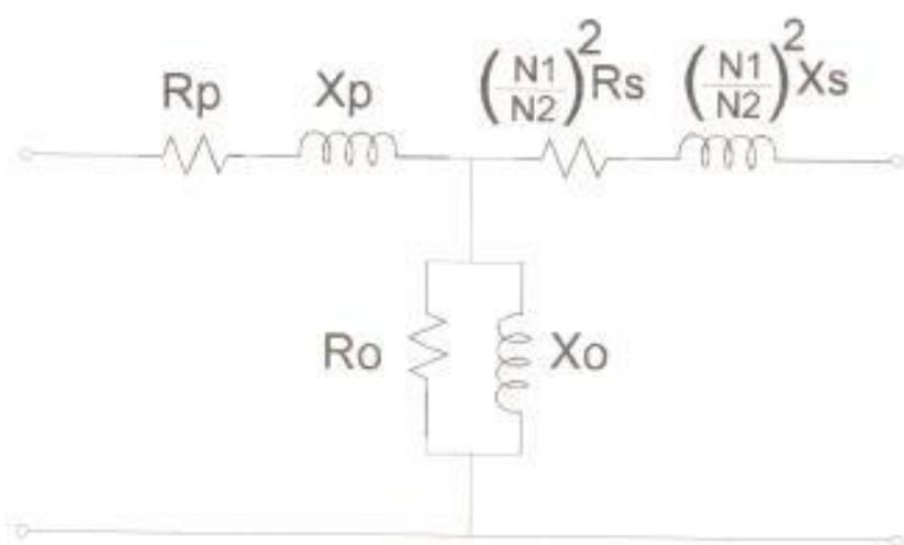
FIG. No 3 CIRCUITO EQUIVALENTE DE UN TRANSFORMADOR
