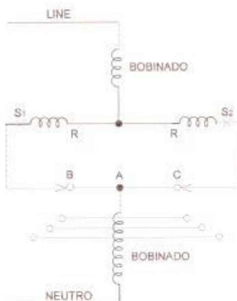
FIG. No 4 CIRCUITO EQUIVALENTE DE UN INTERCAMBIADOR DE TAP
