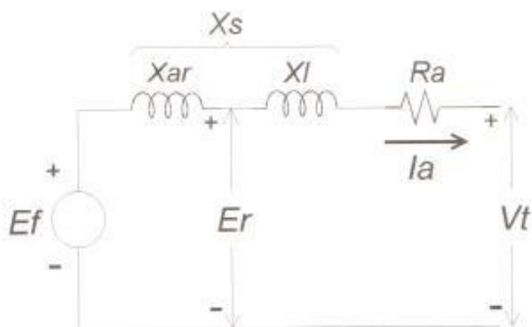
FIG. No 1 CIRCUITO EQUIVALENTE DEL GENERADOR DE CORRIENTE ALTERNA
