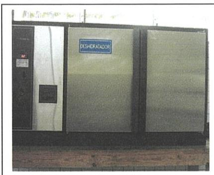
FIGURA 2.3 Secador de Bandeja
